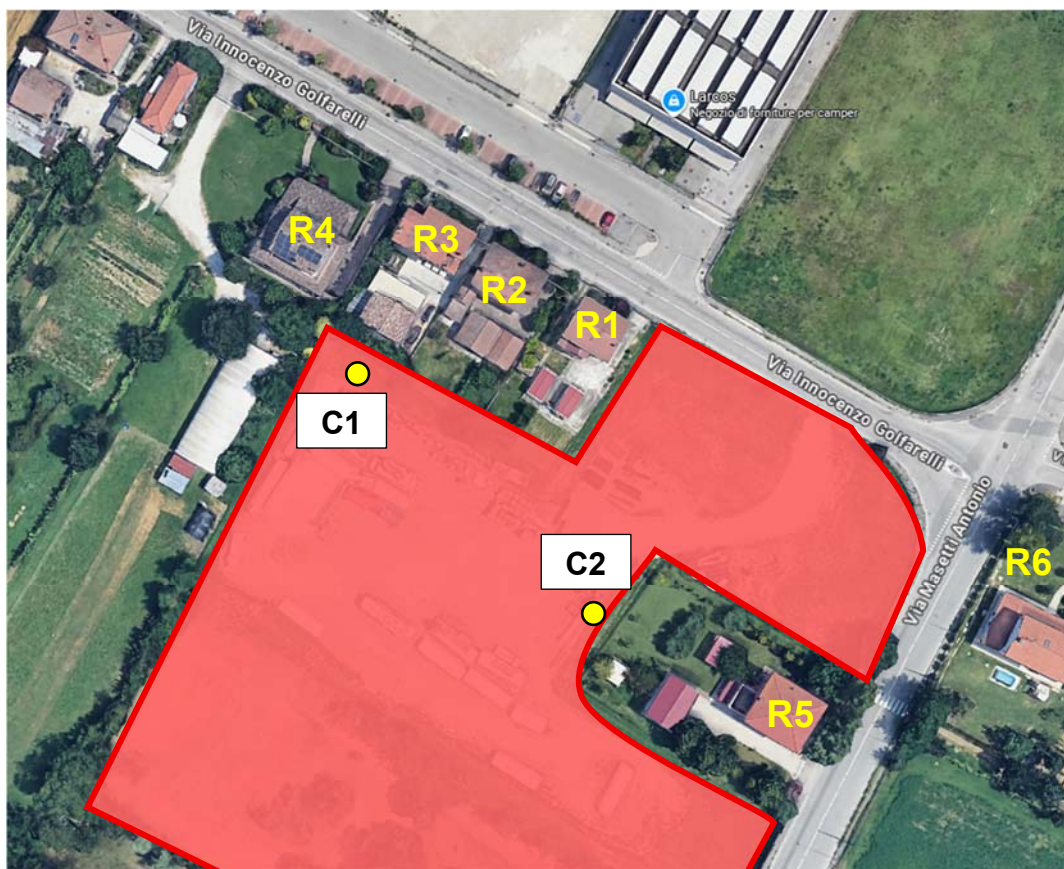
Figura 6. Foto aerea con le postazioni di rilievo fonometrico per la caratterizzazione del rumore residuo
